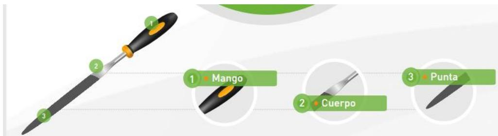
**USO:** Las limas son herramientas manuales diseñadas para conformar objetos sólidos desbastándolos en frío. Se utilizan para desbastar superficies metálicas irregulares
