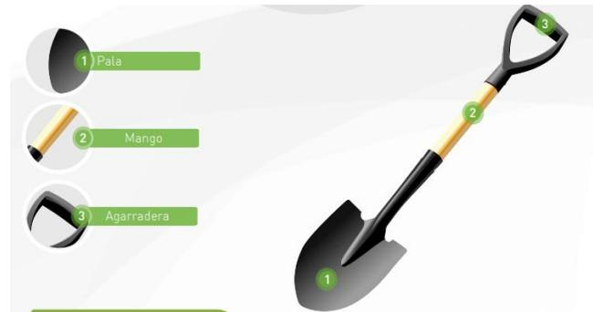
**Uso:** Es una herramienta usada para excavar o remover materiales con movimientos continuos y sincrónicos. Consta de una superficie plana con una ligera curvatura que sirve para cavar en la tierra y transportar el material También de un mango de metal o madera con el que se manipula. La parte lisa suele ser metálica y el mango remata en una agarradera que puede ser recta o curva para poder ejercer mayor fuerza con una de las manos.
