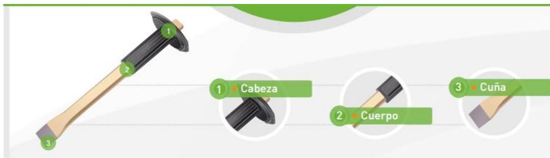
**USO:** Los cincelos son herramientas de mano diseñadas para cortar, ranurar o desbastar material en frío, mediante la transmisión de un impacto. Son de acero en forma de barras, de sección rectangular, hexagonal, cuadrada o redonda, con filo en un extremo y biselado en el extremo opuesto.
