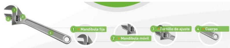
**Uso:** Consta de una pieza fija metálica y otra pieza móvil que se ajusta mediante un hilo sin fin. Algunas cuentan con mango de material aislante y pueden ser utilizadas en trabajos eléctricos. Se utiliza para apretar y aflojar tuercas o pernos, existen en varias medidas.
