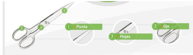
**Uso:** Herramienta que sirve para cortar y está formado por dos hojas de acero de un solo filo, unidas a modo de aspas por un eje para que se puedan abrir y cerrar. Se usan para cortar materiales livianos como papel y plástico, en algunos casos se usan para cortar hojas de metal
