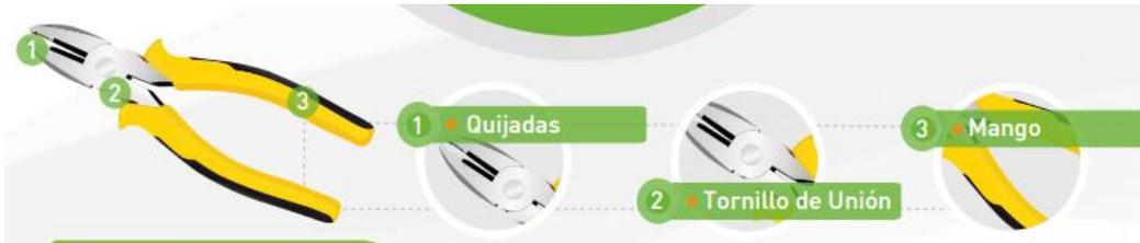
**Uso:** Los alicates son elementos imprescindibles en cualquier equipo básico de herramientas manuales. Son muy utilizados porque sirven para sujetar, doblar o cortar. Existen varios tipos de alicates, entre los que se encuentran los universales, de corte, de presión, de cabeza plana y de cabeza redonda. Son utilizados para procesos mecánicos y eléctricos.
