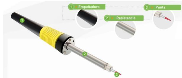
**Uso:** El Cautín es una herramienta utilizada para soldar con estaño. Los cautines eléctricos generan calor debido al paso de una corriente a través de un elemento calefactor, generalmente un alambre de níquel-cromo de alta resistencia enroscado en forma de bobina alrededor de un núcleo de cobre. El calor desarrollado en este último se transmite por conducción a la punta de la herramienta, hecha de acero inoxidable, y de esta a los puntos de unión y a la soldadura.
