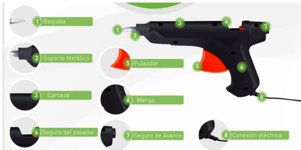
**Uso :** Esta herramienta es usada para aplicar cantidades de silicona derretida a través de una resistencia caliente, la cual es empujada a través de un canal, por medio de un pulsador y es sostenido por medio de un seguro en su pasador. Las pistolas pueden generar baja (250°F) y alta temperatura (380°F), dependiendo la actividad que piense desarrollarse. La silicona viene en forma de barra cilíndrica de varios diámetros, es copolímetro del acetato del etileno vinilo.
